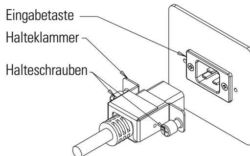
**Abb. 1-9.** Stromkabel
